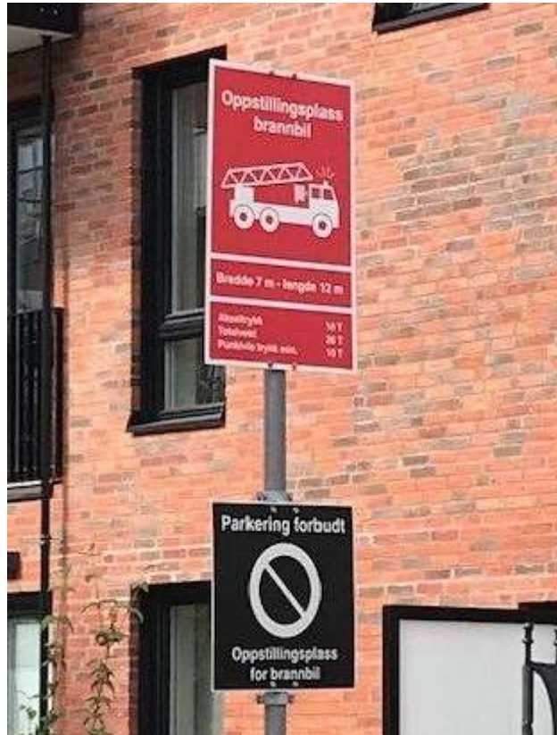
Eksempel på skilting av oppstillingsplass for høyderedskap
